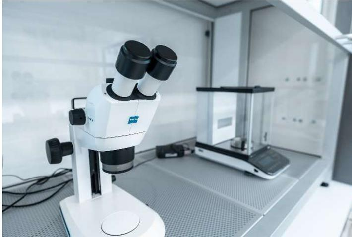
Partikeluntersuchung mit Mikroskopie und Laborwaage in Reinraumatmosphäre im Boltzmann Labor
